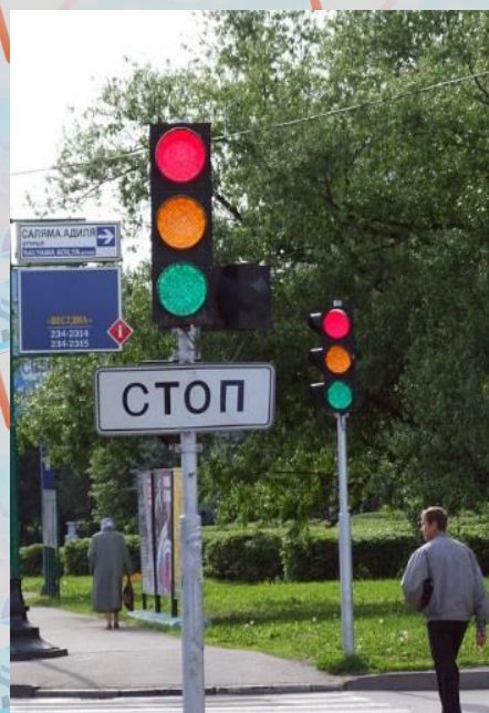
Автомобильный светофор со светодиодными огнями
